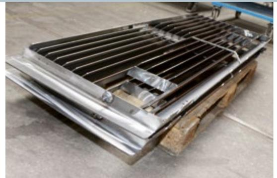
Aus Dünnsblech geschweißte Heckklappe für 55 Tonnen Müllverdichter
