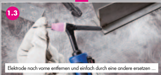
Wolframelektrode durch einen leichten „Daumendruck“ entspannen ...
