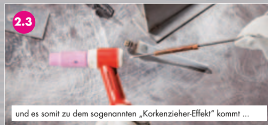
oft muss hier die Brennerkappe komplett entfernt werden, da im Bereich der Spannhülse „Festbrenner“ entstehen können ...
