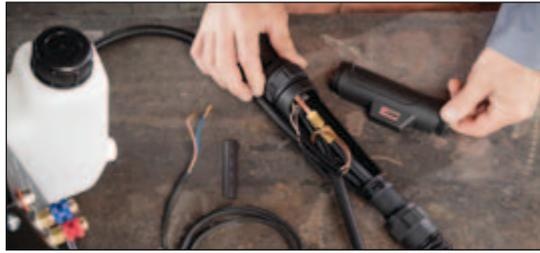
1. Maschinenseitiges Anschlussgehäuse öffnen.
